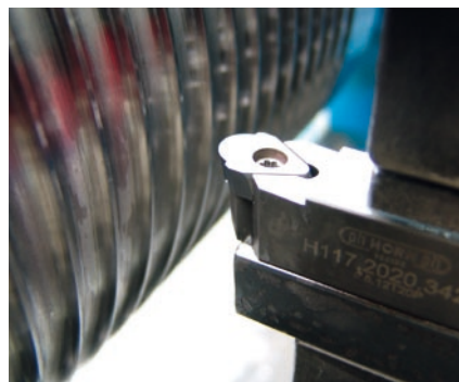
Herausforderung: Man hatte keine Möglichkeit, die Bearbeitungsstabilität durch zusätzliche Abstützung zu erhöhen.
