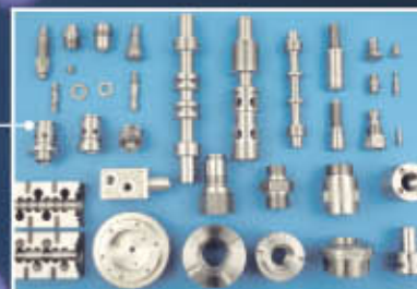
Diverse Drehteile von Mehrspindel-Drehautomaten
